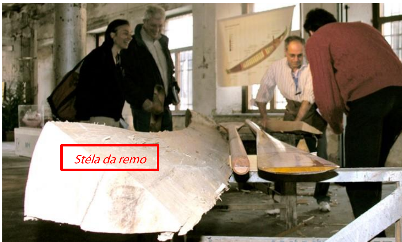
Una stéla da remo e le varie fasi di lavorazione nella bottega di un remer
