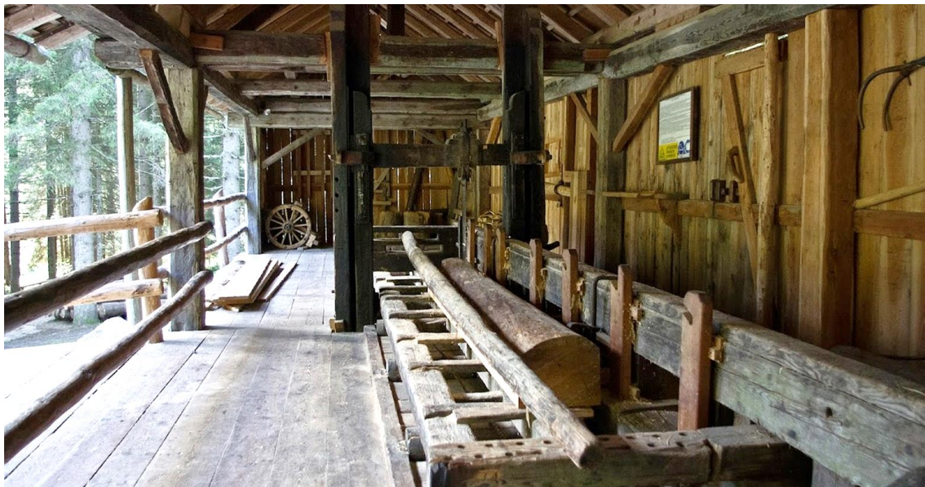
Sega «alla veneziana» ancora in funzione a Malè in Val di Sole (Trentino), in primo piano il «Carro» dove veniva posto il tronco da segare
