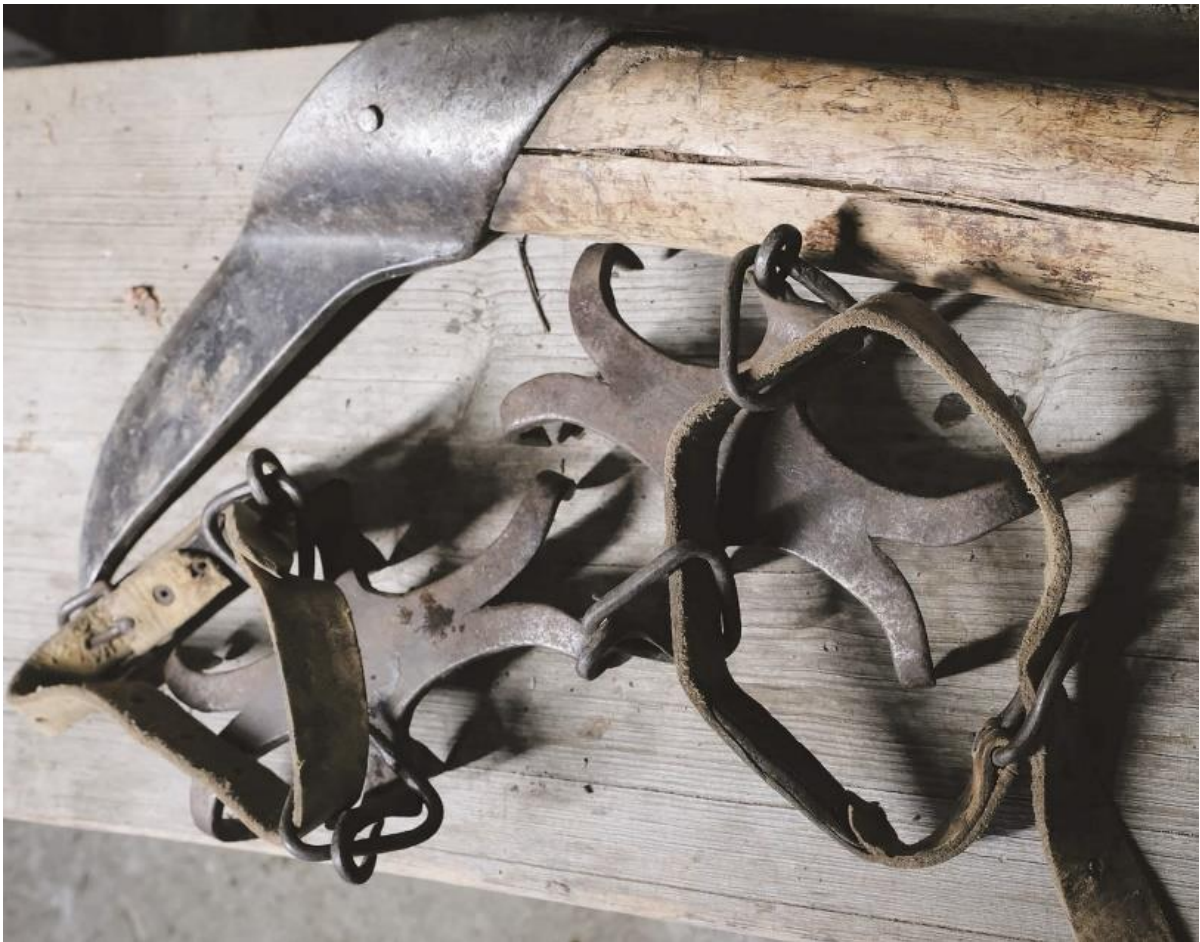
«Grife» (ramponi) a 6/8 punte per consentire ai «menadàs» di restare in equilibrio sui tronchi scivolosi, dietro un «žapìn»
